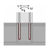
(d) Components stressed primarily in compression
